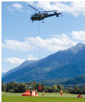
präzise Einweisung durch Feuerwehrfluglotsen zwecks Tankbefüllung mit der Alouette III
